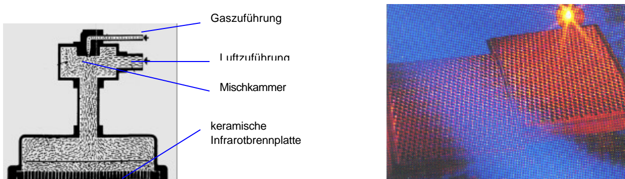
Bild 1: Prinzip eines Gasinfrarotstrahlers mit Zuführung des Gas-Luft-Gemisches
