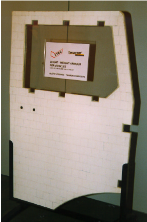
Bild 3.4: Panel für den ballistischen Schutz von Kraftfahrzeugen
