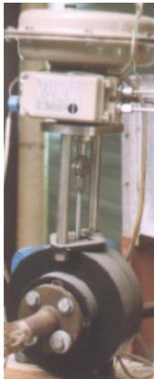
Bild 6: Keramikscheibenschieber in Gipsherstellung
