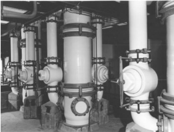
Bild 1: Kolonne mit Küchenhähnen aus Hartporzellan ca. 1955
