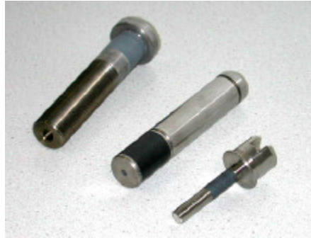
Bild 7: Partielle keramische Beschichtung eines Pumpenkolbens
