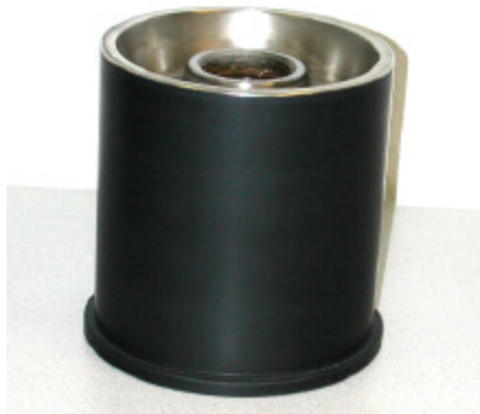
Bild 6: Keramische Beschichtung einer Galette aus Stahl für Spinnanlagen
