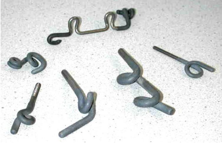
Bild 13: Fadenführer mit hintergriffiger Geometrie
