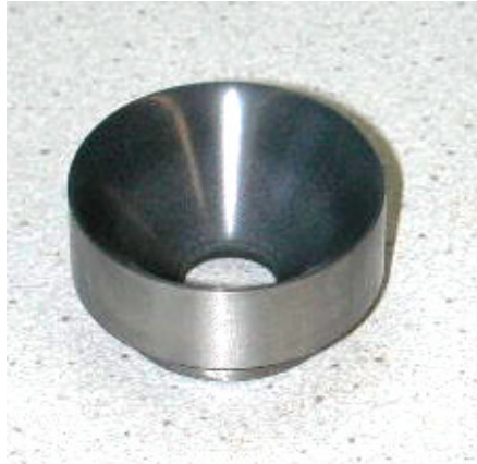
Bild 9: Keramikbeschichtete und polierte Einlaufmündung aus Stahl für die Textilindustrie, Auftreffwinkel des Spritzstrahls > 45^\circ
