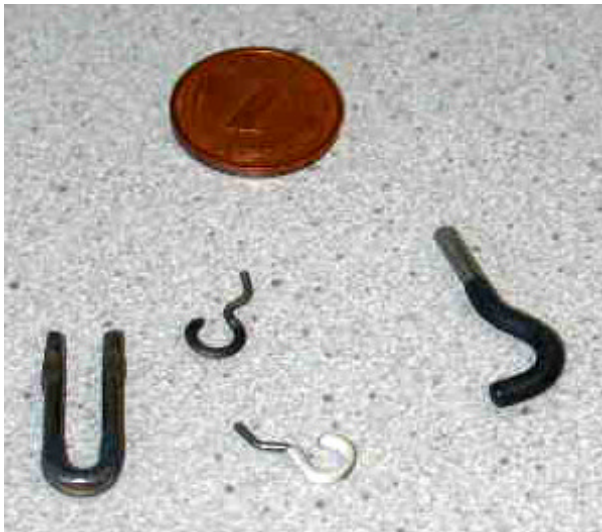
Bild 10: Geometrische Untergrenze für keramikbeschichtete und oberflächenbearbeitete Kleinteile
