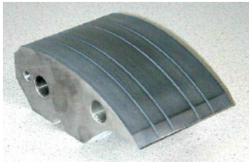
Bild 8: Keramische Beschichtung einer Drahtumlenkung mit bearbeiteten Rillen
