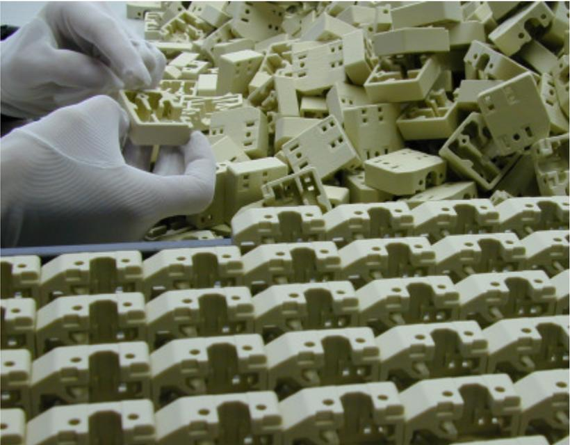
Bild 1: Endkontrolle von Reglersockeln aus Steatitkeramik
