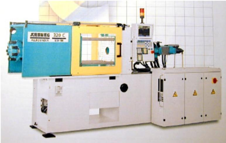
Bild 13: Spritzgußmaschine der Fa. Arburg wie sie bei der Herstellung von Keramikbauteilen zum Einsatz kommt
