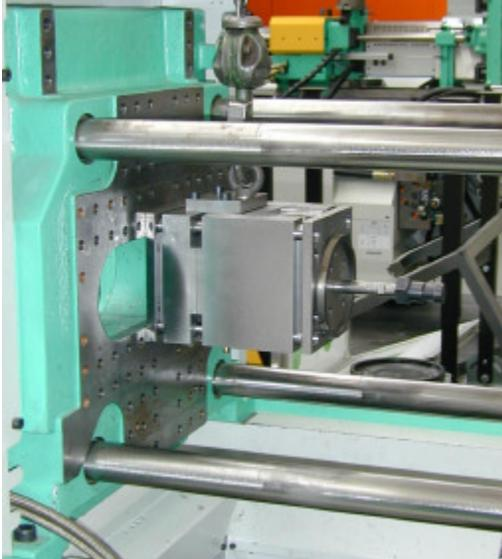
Bild 14: Einbau eines Spritzgusswerkzeugs
