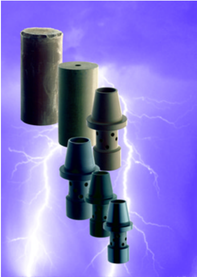
Bild 1: Herstellungsschritte eines komplizierten SiC-Bauteiles durch Grünbearbeitung
