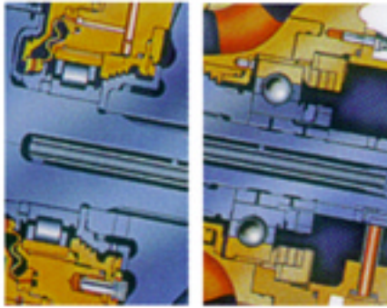
Einsatz von keramischen Rollen und Kugeln in Triebwerken für das Space-Shuttle
