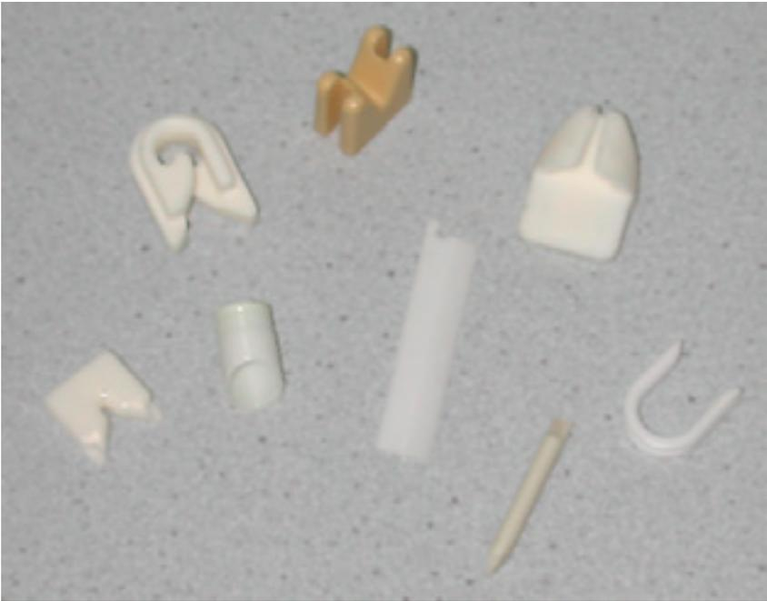
**Bild 5:** Zum Einkleben vorgesehene Spritzgussteile
