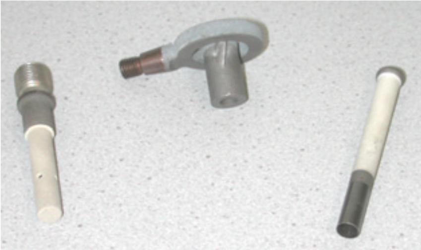
**Bild 4:** Bauteile mit keramischer Isolationsschicht (teilbeschichtet)
