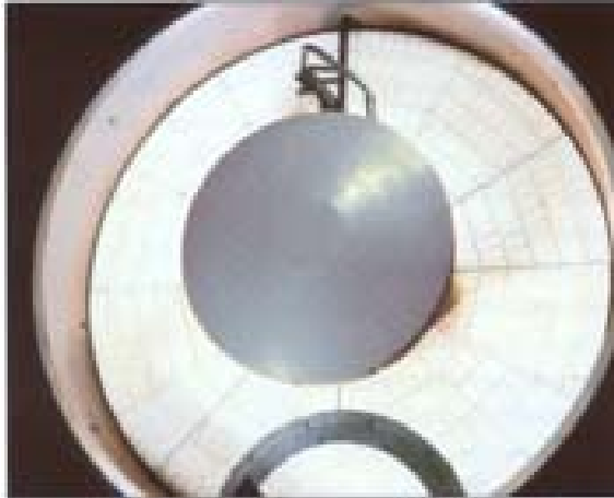
Bild 2a: Mit Aluminiumoxid – Keramik ausgekleidete Tellermischer bringen bis zu fünffache Standzeitverlängerungen gegenüber Stahl und Guss. Anforderungen sind hohe Verschleiß- und Druckfestigkeit.
