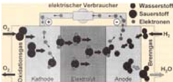
Bild 2j: Hochtemperatur – Brennstoffzelle Der aktive Teil besteht aus den Schichten Kathode/Elektrolyt/Kathode. Itrium stabilisiertes Zirkoniumdioxid wird als Elektrolyt eingesetzt. Die Elektroden bestehen aus Ni/NiO und modifizierten Lanthanmanganit.
