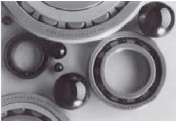
Bild 2d: Wälzlager aus Siliciumnitrid gewinnen wegen ihrer Steifigkeit und überragender Lebensdauer immer größere Bedeutung – nicht nur in der Raumfahrt sondern auch in industriellen Anwendungen. Vorteile geringes Gewicht und guten Trockenlauf.
