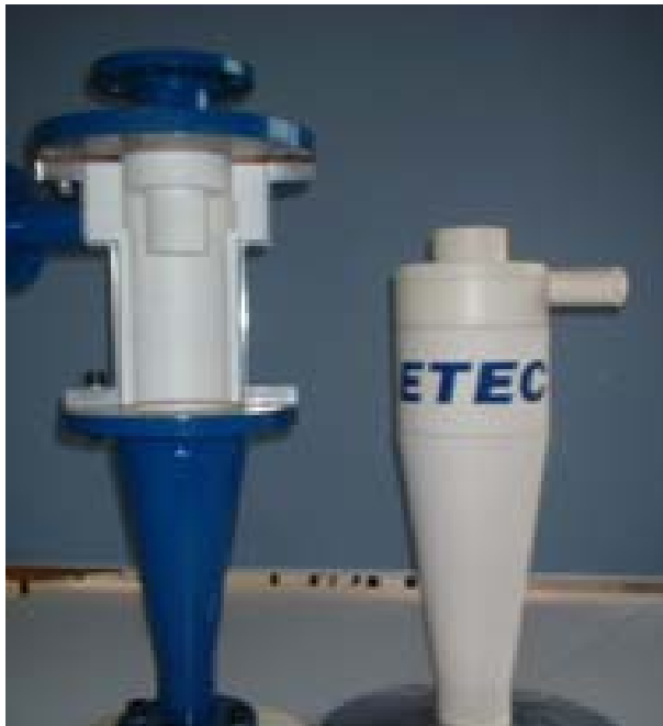
Bild 2e + f: Keramikzyklone bringen beim Klassieren von Rohstoffen bis zu zehnfach höhere Standzeiten als Polyurethan- oder Stahlzyklone. Besonders verschleiß-gefährdet sind der Einlaufbereich und die Auslaufdüse Voraussetzungen sind hohe Erosions- und Korrosionsbeständigkeit
