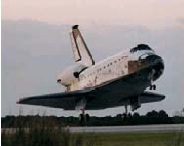
Bild 2j: Hitzeschutzkacheln für Space Shuttle. Die Hitzeschutzkacheln bestehen aus hochreinen Siliciumdioxid – Kurzfasern und einer Beschichtung aus wärmeabstrahlendem, schwarzem Siliciumtetraborid. Gefordert werden hohe Wärmeisolation bei Temperaturen bis 1.400°C und äußerst niedrige Dichte. Ähnliche Werte werden auch mit \text{Al}_2\text{O}_3 -Fasern erreicht
