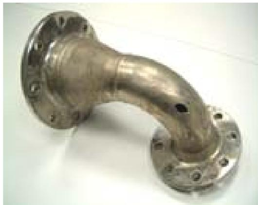
**Bild 15:** defekter Rohrbogen aus Spezialstahl
