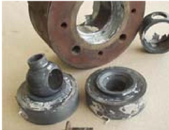
**Bild 11:** Bauteile aus  $\text{Si}_3\text{N}_4$  in einem Kugelhahn für flüssiges Zink
