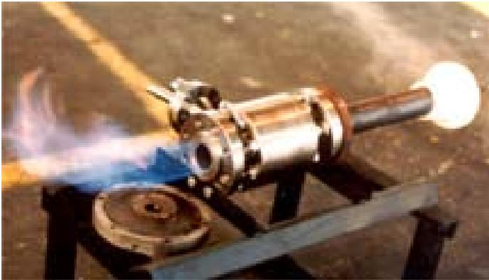
**Bild 8:** HT – Kugelhahn auf dem Prüfstand
