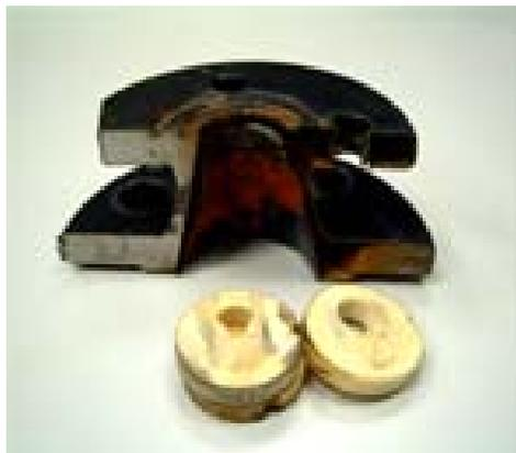
**Bild 13:** Korrodierte Teile nach Einsatz im flußsäurehaltigen Medium
