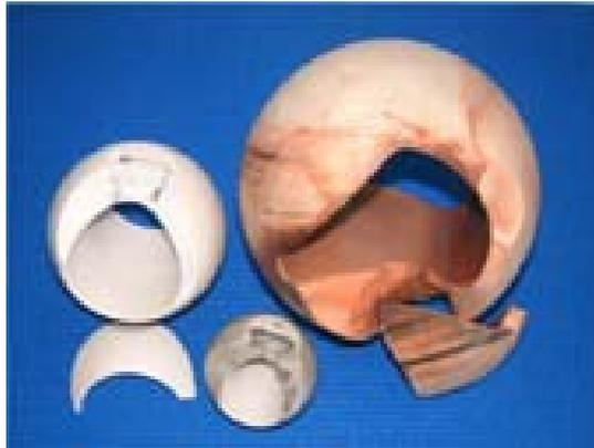
**Bild 6:** Kugelbrüche an Kugeln DN 80, DN 50 und DN 25
