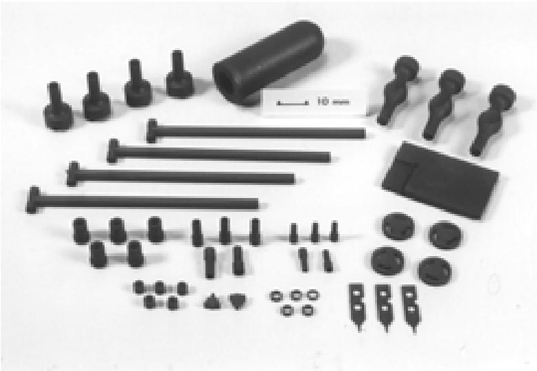
**Bild 5:** Endkonturnah spritzgegossene SN-Teile für u. a. die Medizintechnik
