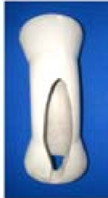
Zerstrahlter Porzellanrohrbogen DN 50
