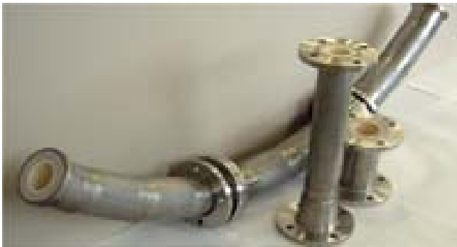
Bild 12: Rohrbogen DN 50, PN 16, R 1000 einer \alpha -Gips-Anlage
