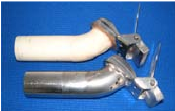
Bild 15: Keramischer und defekter metallischer Einlaufkrümmer DN 40 nach gleicher Einsatzzeit von 6 Monaten
