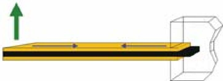
**Bild 8:** Auslenkung eines trimorphen Biegewandlers.
