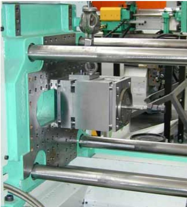
**Bild 13:** Einbau eines Spritzgusswerkzeugs
