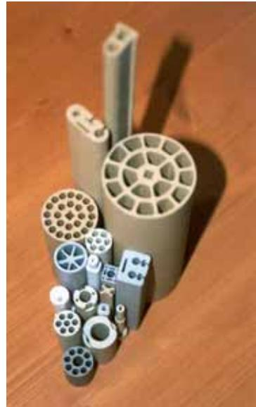
**Bild 4:** Beispiele für extrudierte Keramikbauteile
