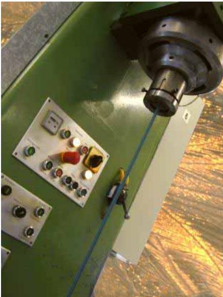
**Bild 3:** Kolbenpresse für das vertikale Extrudieren von Keramikmassen
