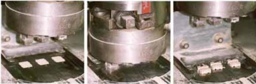
**Bild 8:** Trockenpressen „live“!
