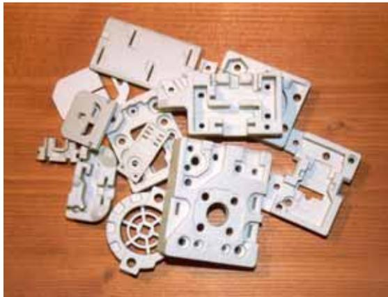
**Bild 6:** Verschiedene Trockenpressteile aus Steatit
