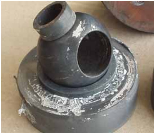
Bild 9: Bauteile aus \text{Si}_3\text{N}_4 in einem Kugelhahn für flüssiges Zink
