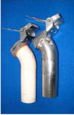
Rohrbogen aus Metall und aus Keramik nach 6 Monate Einsatz
