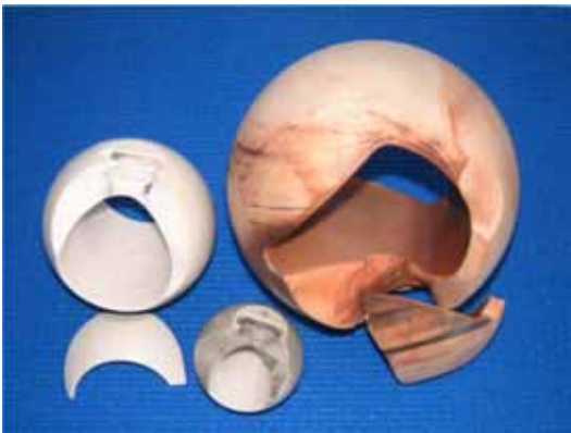
Bild 5: Kugelbrüche an Kugeln DN 80, DN 50 und DN 25
