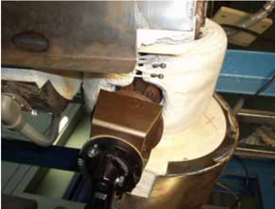
Bild 16: Keramikarmatur mit Heizmanschette
