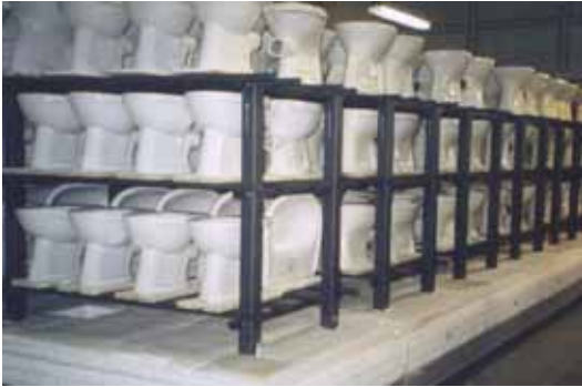
Bild 4: Brennhilfsmittel aus SISIC zum Sintern von Sanitärporzellan
