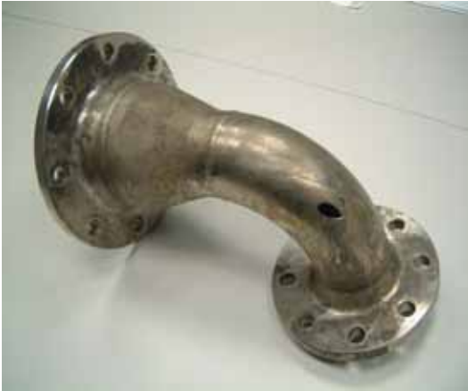
Bild 12: defekter Rohrbogen aus Spezialstahl
