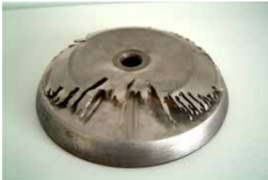
Bild 10: verschlissener Kegel aus Spezialstahl
