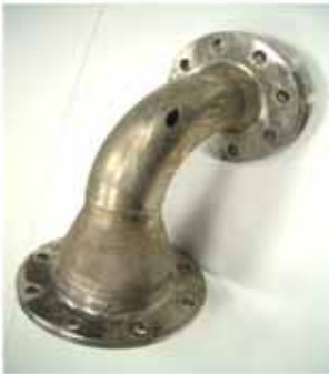
Defekter Rohrbogen aus Edelstahl
