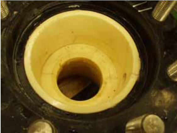
Bild 9: Armatur mit \text{Al}_2\text{O}_3 –Auskleidung nach Thermoschockbelastung
