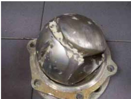
Bild 11: verschlissene Kugel aus Edelstahl
