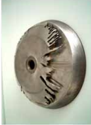
Verschlissener Kegel aus Spezialstahl
