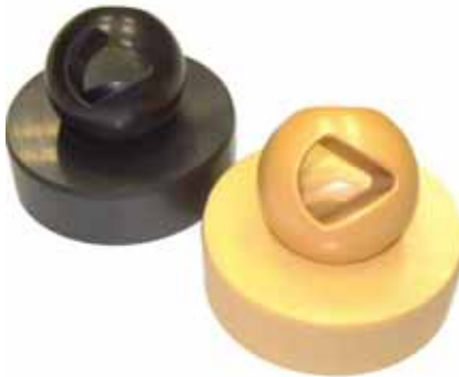
Bild 14: Keramikugel mit Rundheit 2,4 \mu\text{m}
