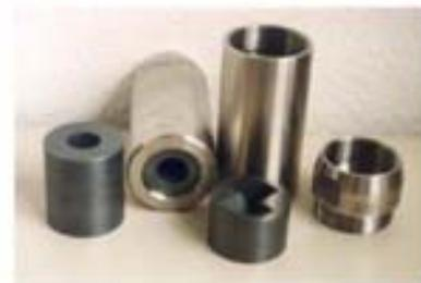
Segmentierte SiC-Düse mit Halterung
