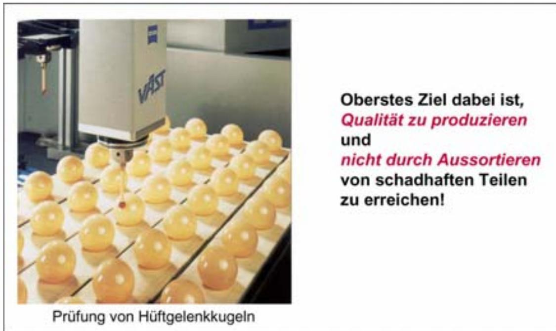
**Bild 40:** Prüfung von Hüftgelenkkugeln (Prooftest)
