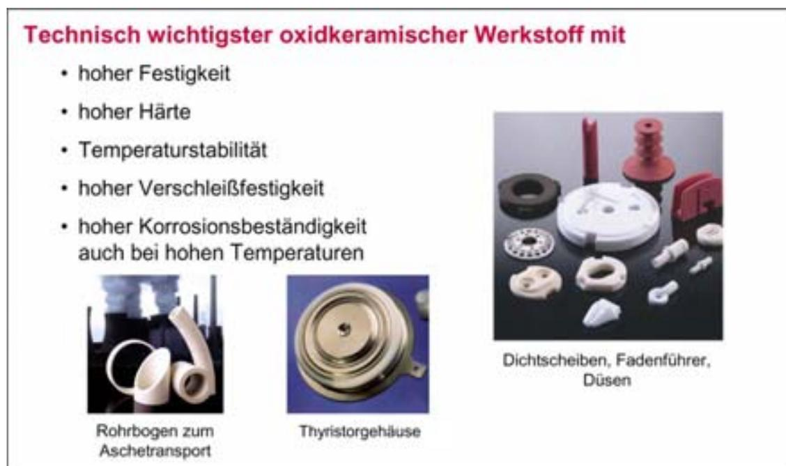
**Bild 31:** Aluminiumoxid ( $\text{Al}_2\text{O}_3$ )
