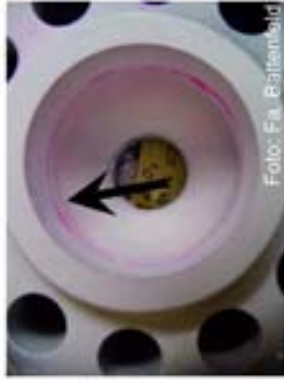
Umlaufender Tangentialriss (Farbeindringverfahren)
