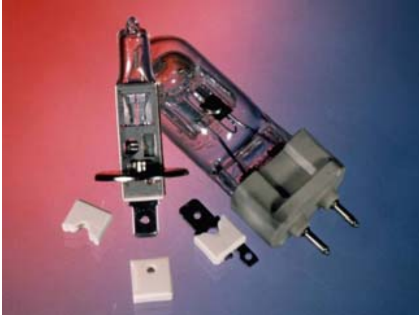
Bild 2: Keramische Sockel und Halterungen für Halogen- und Gasentladungslampen. Wegen der starken Temperatureinwirkung bei extremer Dauerbelastung und UV-Strahlung wird Keramik eingesetzt.
