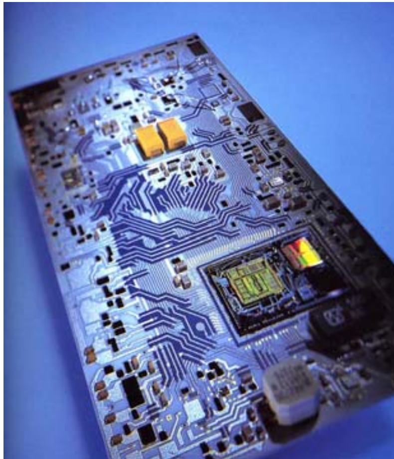
Bild 1: Die Hybridschaltung für ein stufenloses Automatikgetriebe wurde auf Keramikbasis entwickelt, um höchsten Belastungen standzuhalten. Die Schaltung wird direkt in den Hydraulikblock des Getriebes eingebaut.
