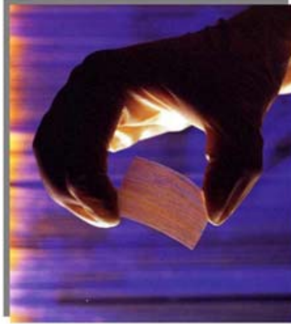
Einlaminierte Piezo-Fasern als Vorstufe für Sensormodule Quelle: Fraunhofer Gesellschaft
