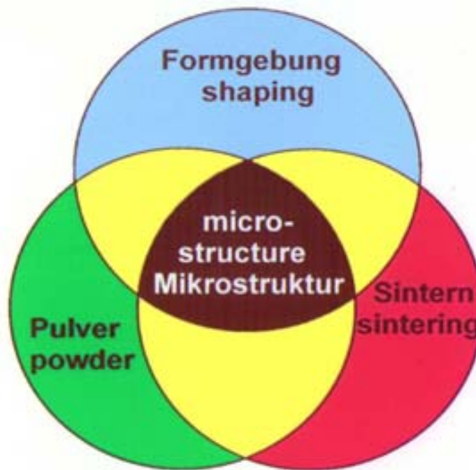
Bild 1: Einfluss von Rohstoff und Prozesstechnik auf das Gefüge der Keramik
