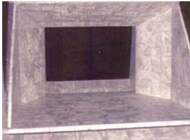
Bild 4: Gichteinlauf eines Hochofens
