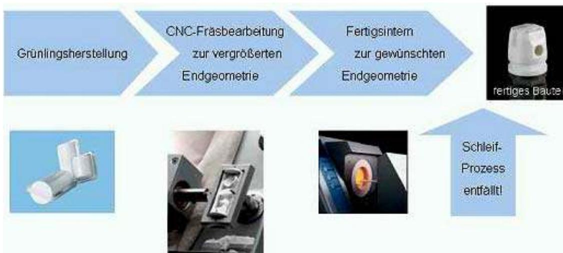
**Bild 4:** Schematischer Bearbeitungsprozess für feinmechanische Präzisionsbauteile aus Y-TZP
