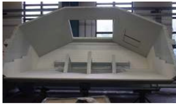
Bild 8: Förderhunte für die Beschickung von Hochöfen: Stahl-Keramik-Verbund
