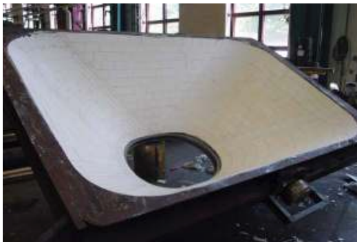
Bild 10: Verfahrbare Bunker im Hochofen
