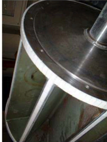
Rotor: Keramikscheiben geklemmt Dichtflächen geschliffen
