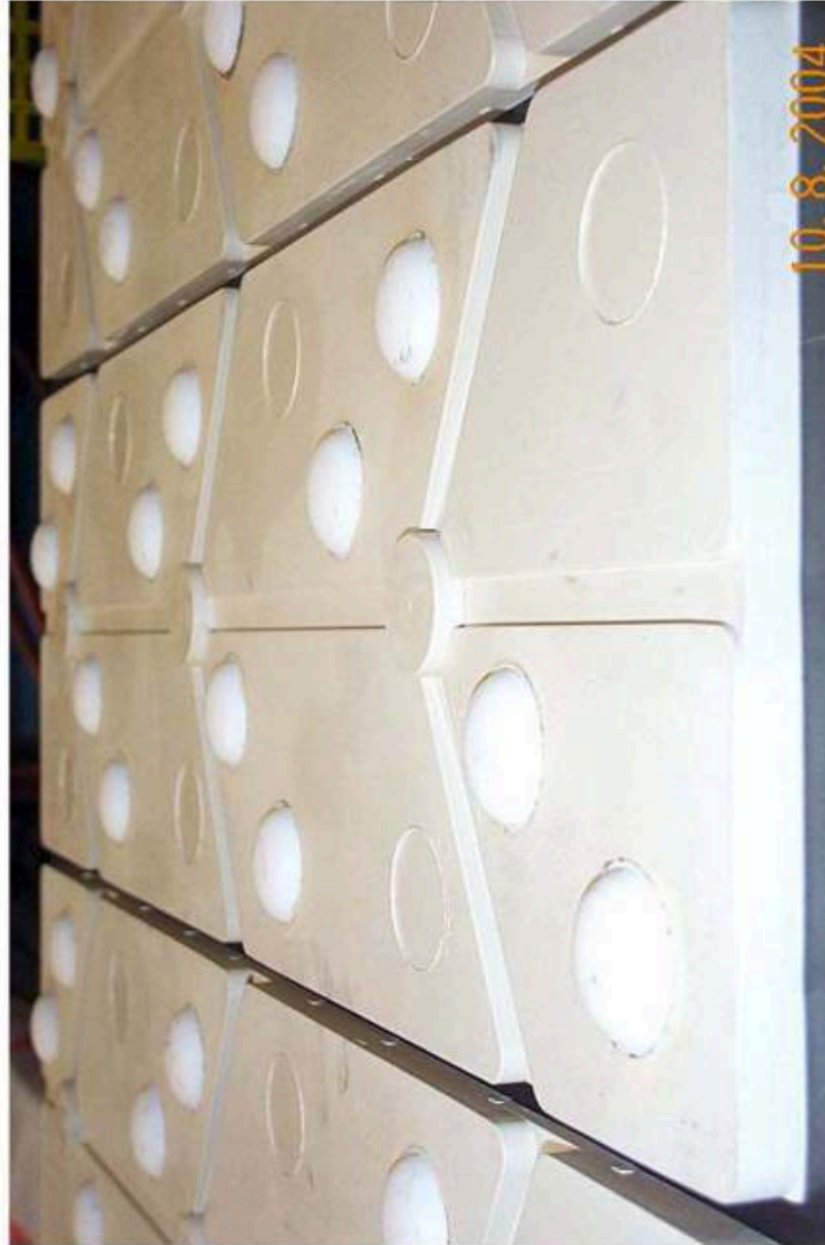
Aloslide - System: Keramik / Spezialkautschuk - Verbund
