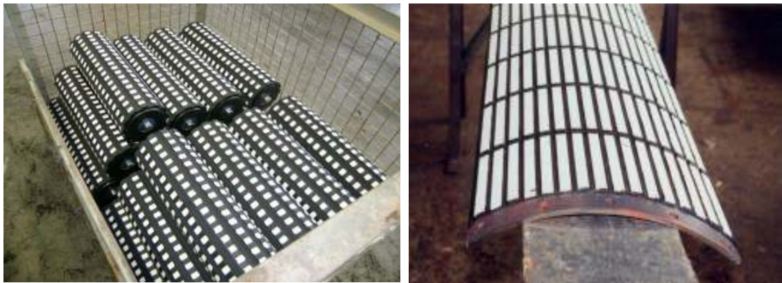
Bild 11: Belegung von Antriebsrollen von Förderbändern: Stahl-Gummi – Keramik – Verbund
