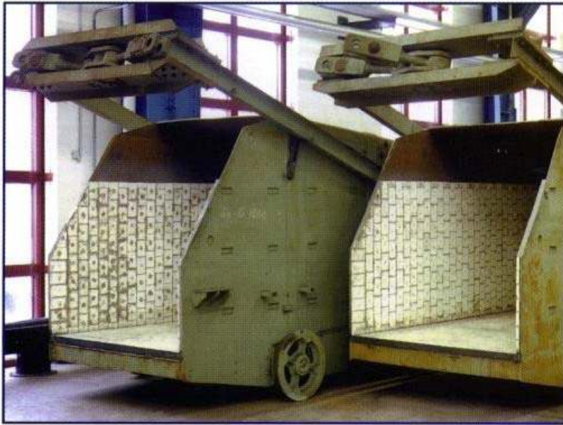
Bild 8: Förderhunte für die Beschickung von Hochöfen: Stahl-Keramik-Verbund
