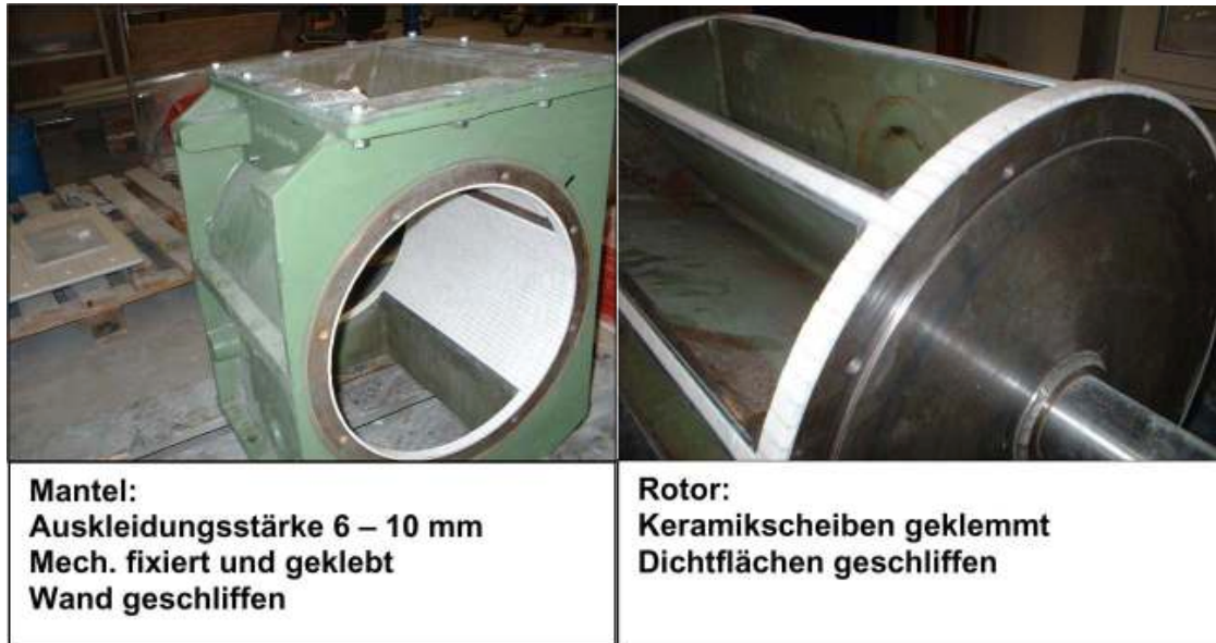
Bild 20: Mantel und Rotor mit Aluminiumoxidkeramik - Verschleißschutz
