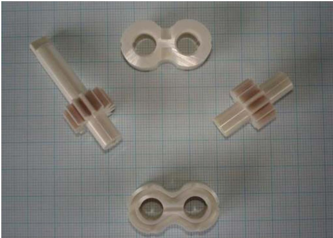
**Bild 5:** Zahnradgruppe für Pumpe aus  $ZrO_2$  Y-TZP
