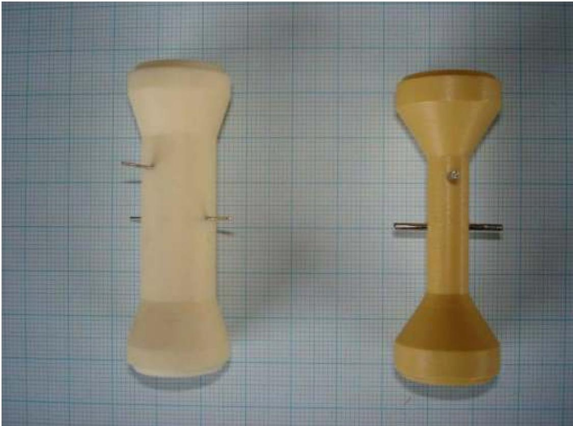
**Bild 4:** Direkt druckfest eingesinterte Kontaktdrähte in Al<sub>2</sub>O<sub>3</sub> oder ZrO<sub>2</sub> Mg-PSZ
