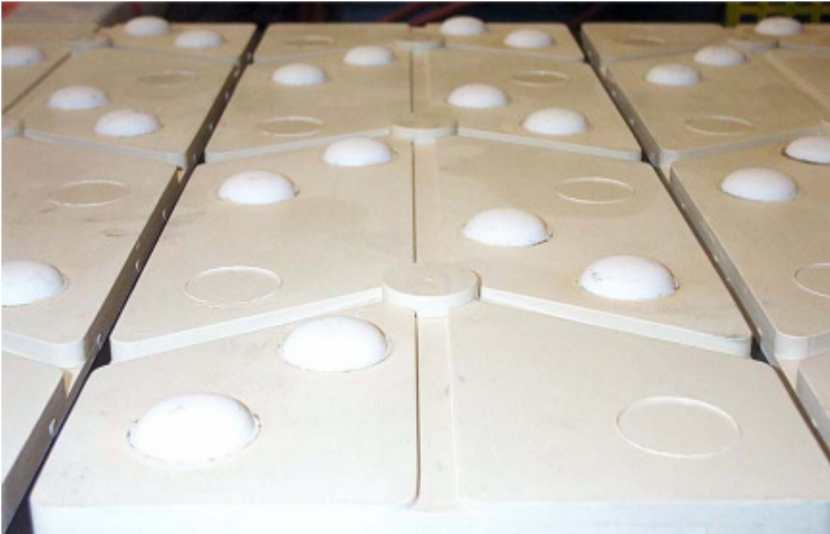
Bild 25: Keramik - Anlaufspur für Skisprungschanzen
