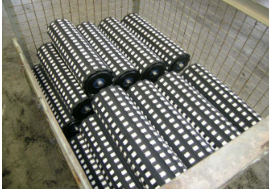
Bild 7: Belegung von Antriebsrollen von Förderbändern: Stahl-Gummi – Keramik - Verbund
