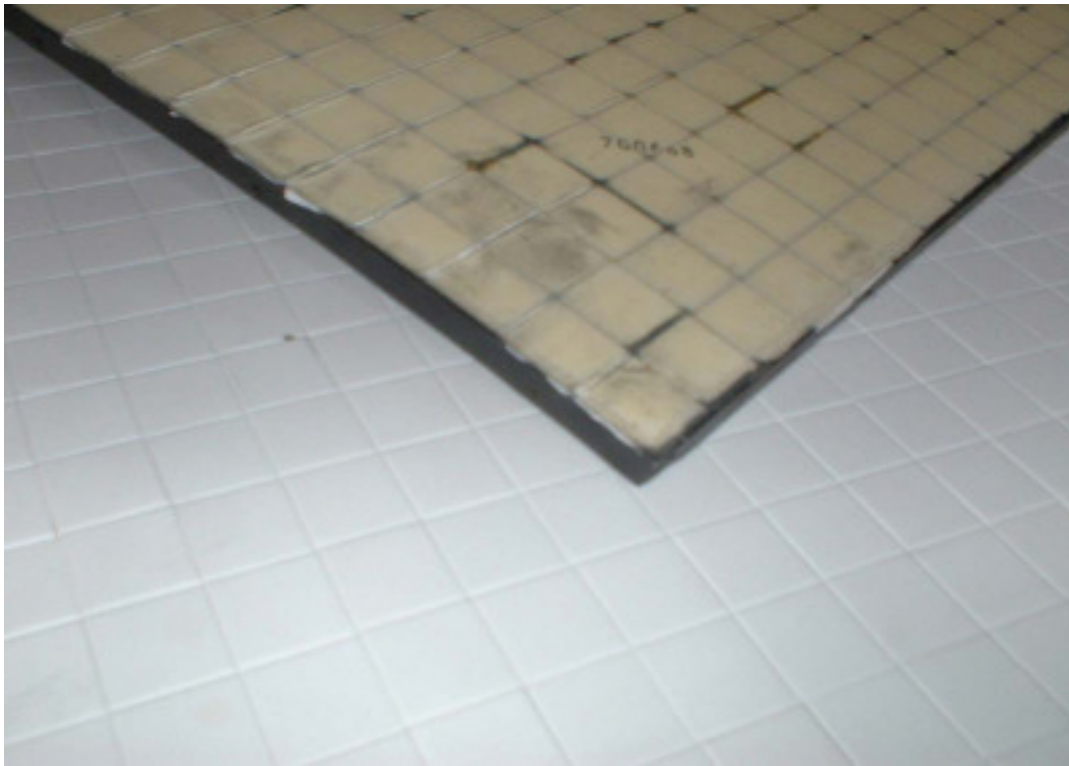
Bild 5: Mosaikmatten, einvulkanisiert in Kautschuk
