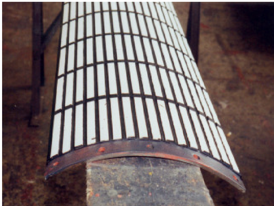
Bild 8: Belegung von Antriebsrollen von Förderbändern: Stahl-Gummi – Keramik - Verbund
