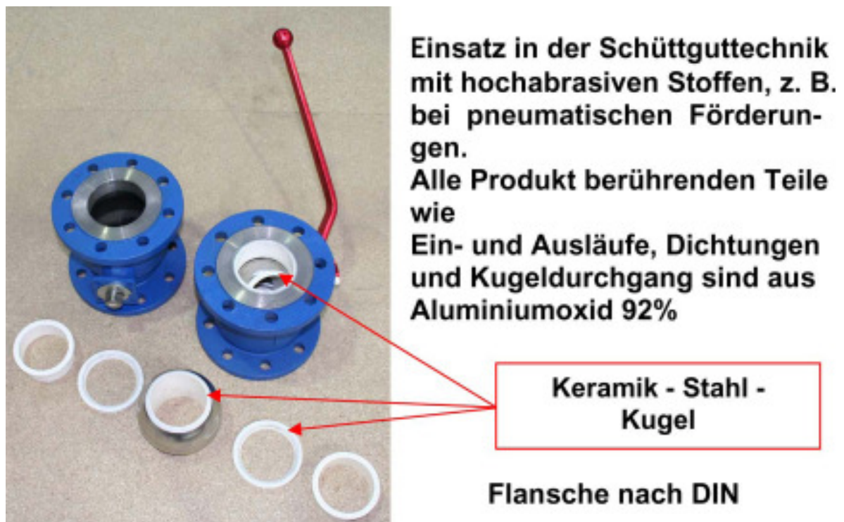
Bild 14: Patentierter Keramik - Kugelhahn
