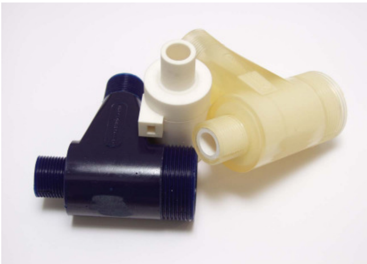
Bild 18: Zyklonkopf: Aluminiumoxid / PU – Verbund
