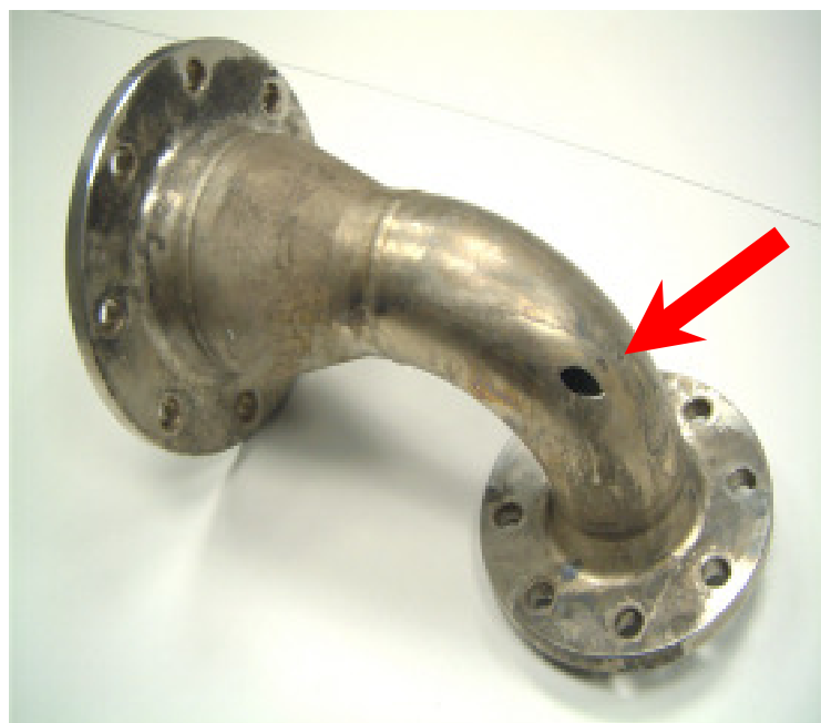
Bild 7: Defekter Rohrbogen aus Edelstahl
