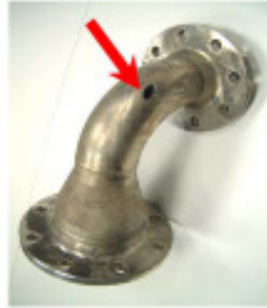
Defekter Rohrbogen aus Edelstahl
