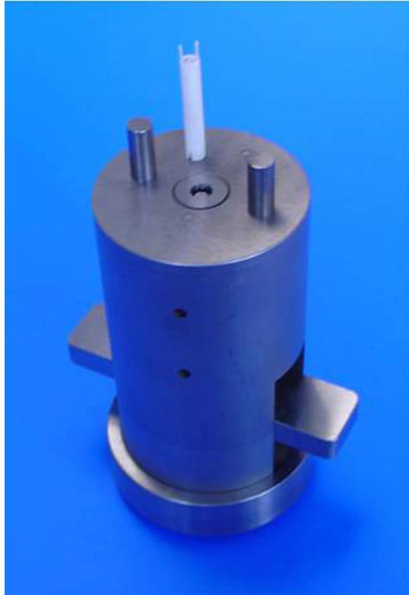
**Bild 10:** Heißgießwerkzeug Außentiegel
