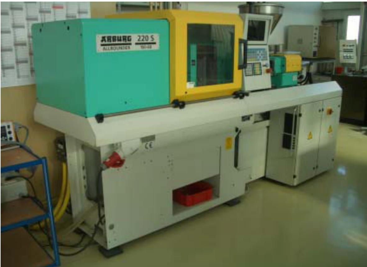
**Bild 2:** Spritzgussmaschine der Fa. Arburg
