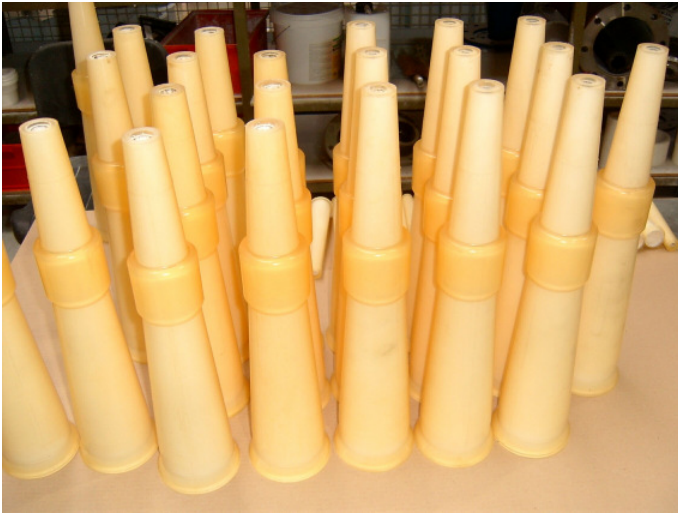
Bild 15: Hydrozyklone (Cleaner), Keramik-Kunststoff-Verbund
