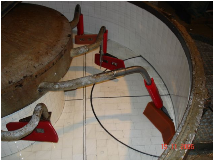
Bild 13: Keramische Mischerauskleidung für Transportbeton
