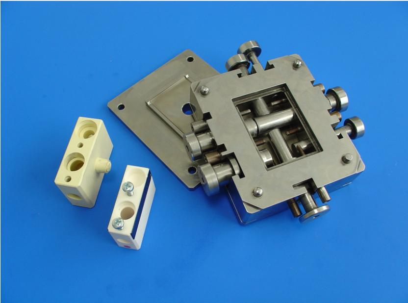
**Bild 5:** Heißgießwerkzeug „Lampenfassung“
