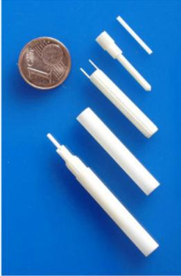
4 Keramikbauteile Miniaturfixpunktziegel
