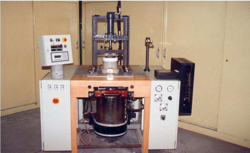
**Bild 4:** Heißgießmaschine
