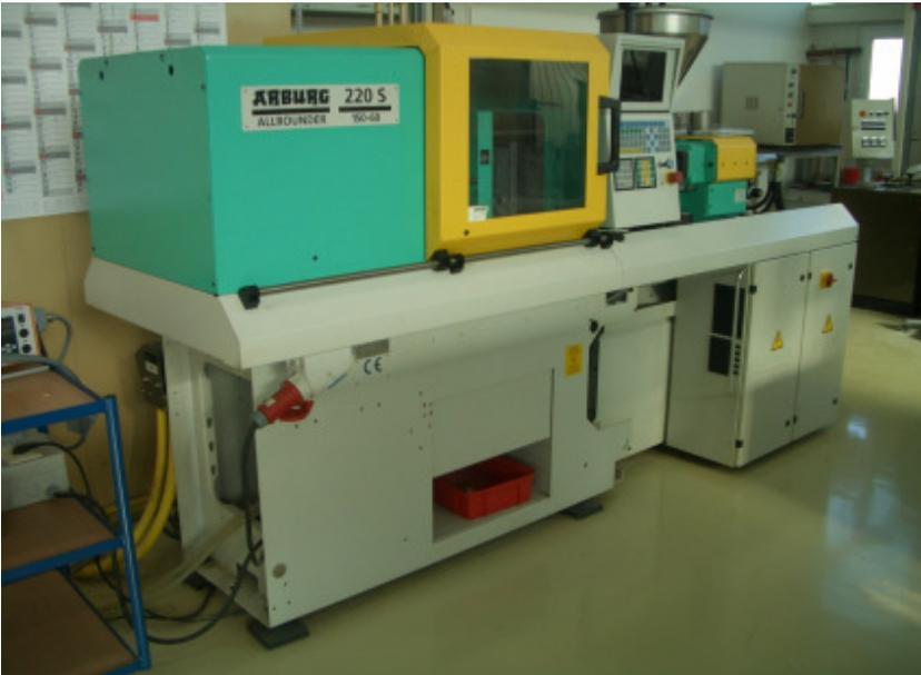
**Bild 2:** Spritzgussmaschine der Fa. Arburg
