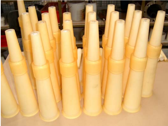
Bild 15: Hydrozyklone (Cleaner), Keramik-Kunststoff-Verbund
