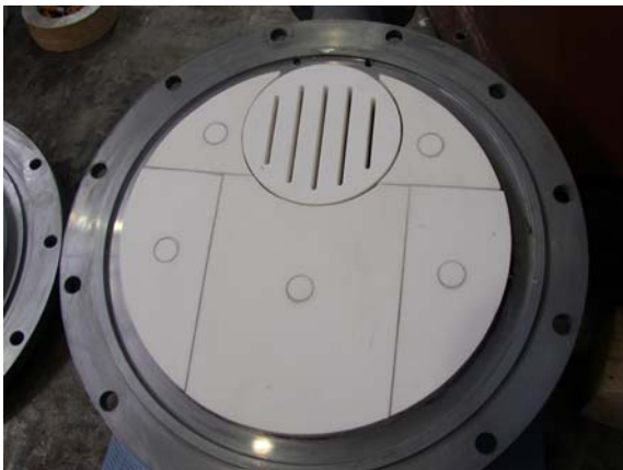
Bild 12: Keramisches Austragsieb einer Exenterschwingmühle
