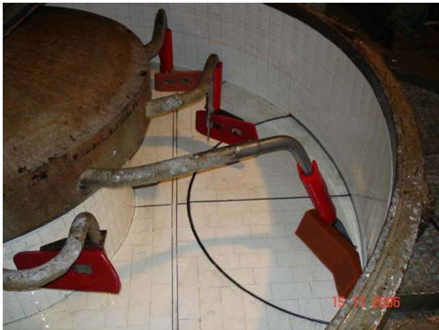
Bild 13: Keramische Mischerauskleidung für Transportbeton
