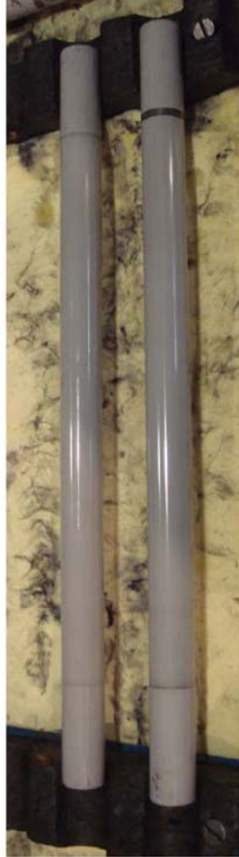
Oberflächen der keramischen Walzen nach 4 Walzstichen
