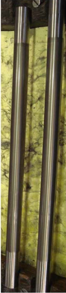
Walzustand von PM Walzen nach einem Stich im 20-Walzen-Sendzimirgerüst
